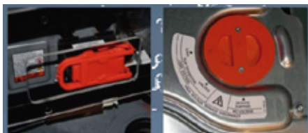
Dispositivos de desconexión.
