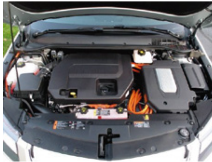
Foto 2. Batería con cables anaranjados.
